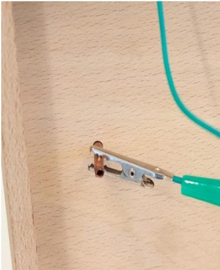
Abbildung 11: Die Krokodilklemme kann an der Unterseite des durchbohrten Kupferrohrs befestigt werden.
