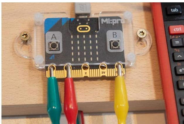
Abbildung 15: Die Krokodilklemmen der zusätzlichen Kontaktstelle werden an Pin 1 des micro:bit angeschlossen.
