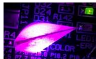
Fig. 5 : La diode RGB a été ici recouverte d'un papier calque pour mieux diffuser la lumière.
