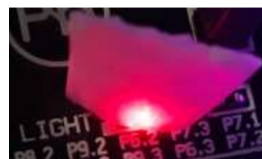
Fig. 12 : La diode rouge a été ici recouverte d'un papier calque pour mieux diffuser la lumière.
